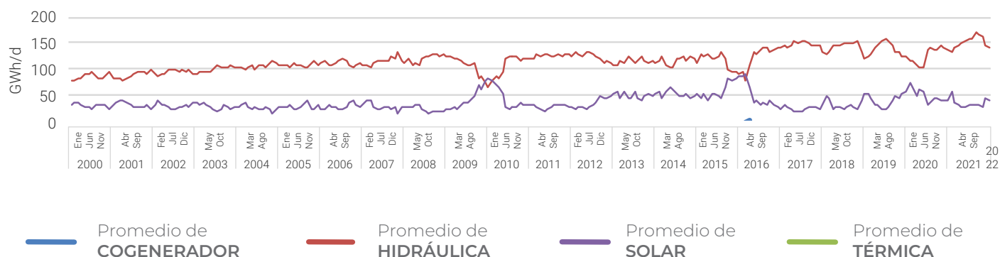
Figura 1: Generación Real de electricidad en el despacho centralizado (2000 - 2022), Fuente XM, Calculos ANDEG
