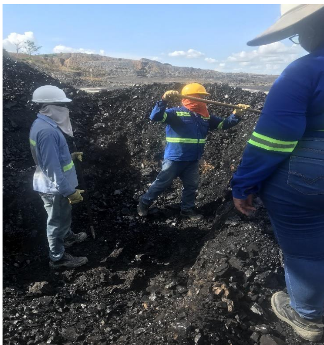
Ilustración 6 Toma de muestra del carbón en mina Córdoba
